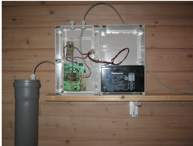
Abbildung 2: Der Zisternensensor im Probetrieb
